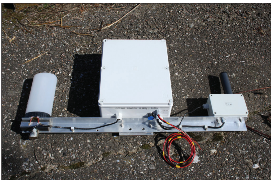
Billedet viser 10 og 24 GHz beaconerne med 10 GHz antenne til venstre og 24 GHz PA og antenne til højre. I toppen af boksen, som huser senderne, sidder GPS-antennen.
