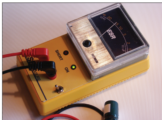
Figur 6. Her er værkstedsudgaven. Af udgaven med leadede komponenter. Lidt klunget, men med en god opløsning på skalaen
