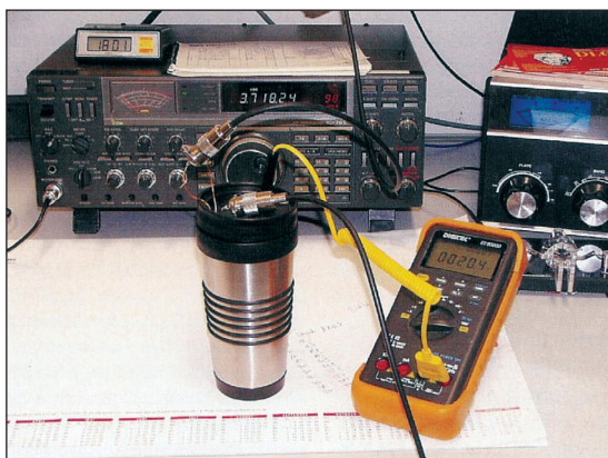
Figur 6. Kalorimetrisk måling af tab i balun.
