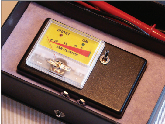
Figur 8. SMD versionen. Bemærk forskellen på kalibreringen af de 2 instrumenter.
